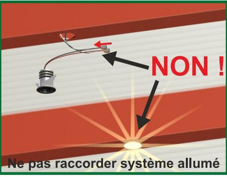
Débrancher le boîtier et attendre 5 secondes avant de manipuler les raccords
